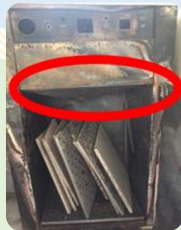
烘箱爆炸燃燒後外觀 (鐵板因爆炸向下突出)
