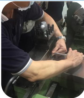
圖1-操作內六角扳手正確動作
