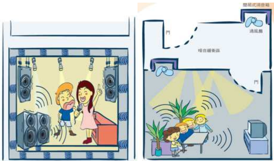
圖 4 擴音設施之噪音防制措施
