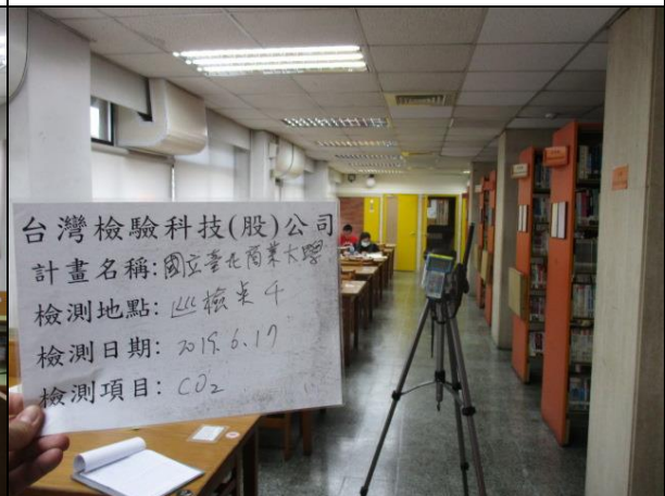
說明：室內空氣品質檢測 (CO 2 巡檢) 日期：2019/06/17 地點：巡檢點 4
