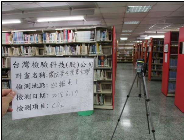
說明：室內空氣品質檢測 (CO 2 巡檢) 日期：2019/06/17 地點：巡檢點 1
