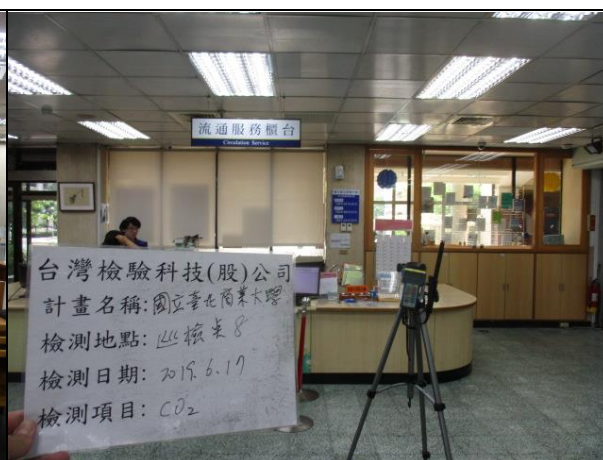
說明：室內空氣品質檢測 (CO 2 巡檢) 日期：2019/06/17 地點：巡檢點 8
