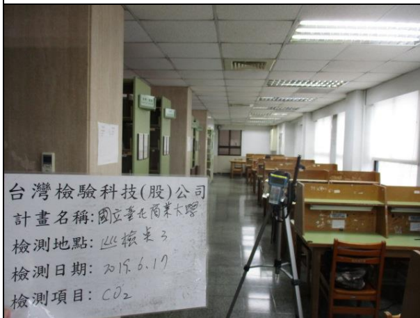
說明：室內空氣品質檢測 (CO 2 巡檢) 日期：2019/06/17 地點：巡檢點 3
