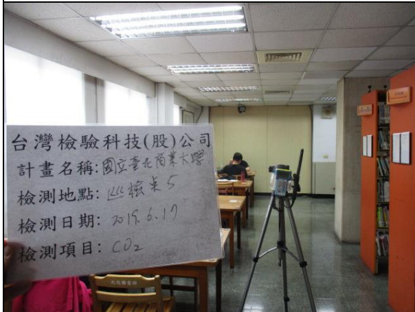
說明：室內空氣品質檢測 (CO 2 巡檢) 日期：2019/06/17 地點：巡檢點 5
