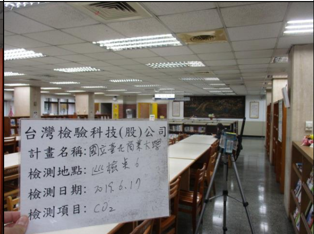
說明：室內空氣品質檢測 (CO 2 巡檢) 日期：2019/06/17 地點：巡檢點 6
