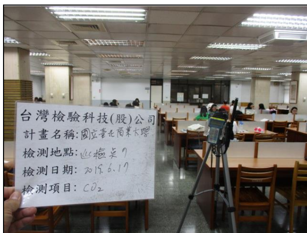
說明：室內空氣品質檢測 (CO 2 巡檢) 日期：2019/06/17 地點：巡檢點 7
