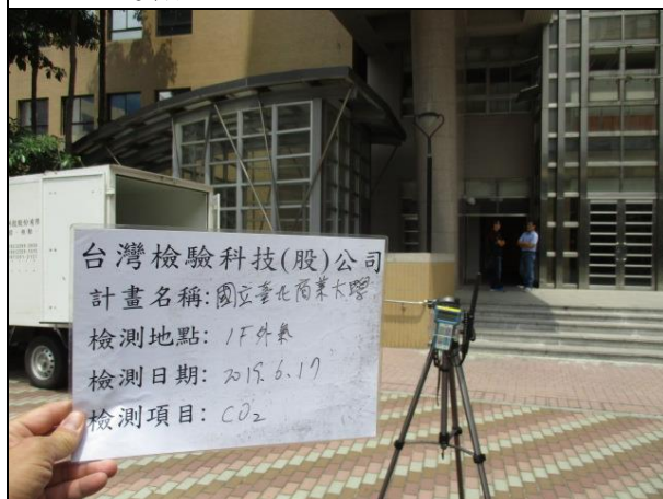
說明：室內空氣品質檢測 (CO 2 巡檢) 日期：2019/06/17 地點：1F 外氣
