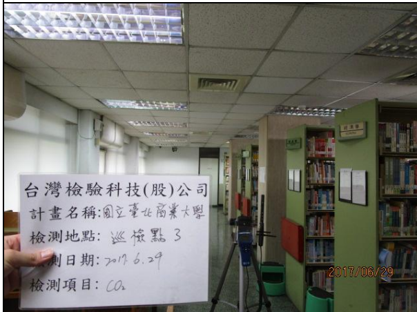
說明：室內空氣品質檢測 (CO 2 巡檢) 日期：2017/06/29 地點：巡檢點 3
