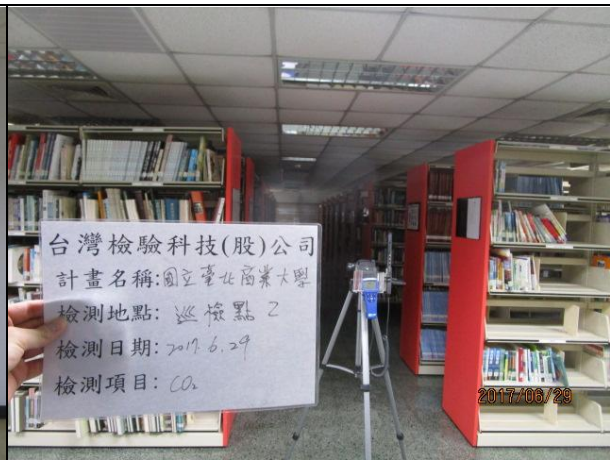
說明：室內空氣品質檢測 (CO 2 巡檢) 日期：2017/06/29 地點：巡檢點 2
