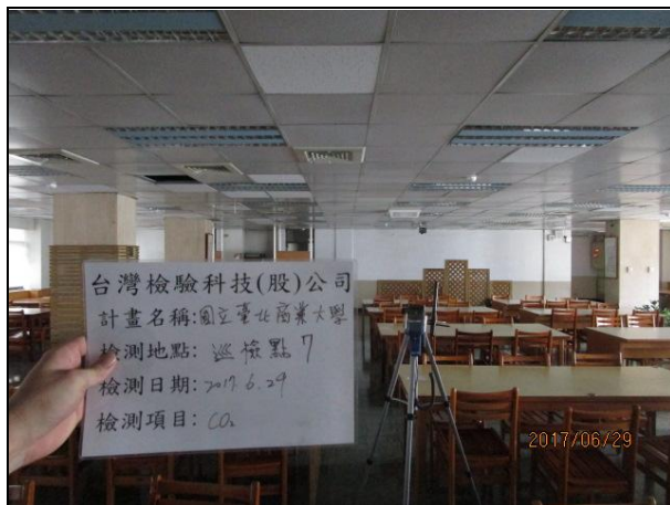
說明：室內空氣品質檢測 (CO 2 巡檢) 日期：2017/06/29 地點：巡檢點 7
