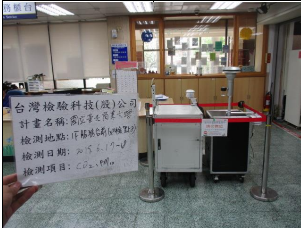
說明：室內空氣品質檢測(CO 2 、PM 10 ) 日期：2019/06/17~2019/06/18 地點：1F 服務台前(巡檢點 8)(#5)
